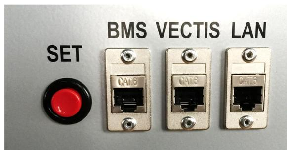
Am Ende verbindet man die BMS Buchse mit einer Buchse am Batteriespeicher.
