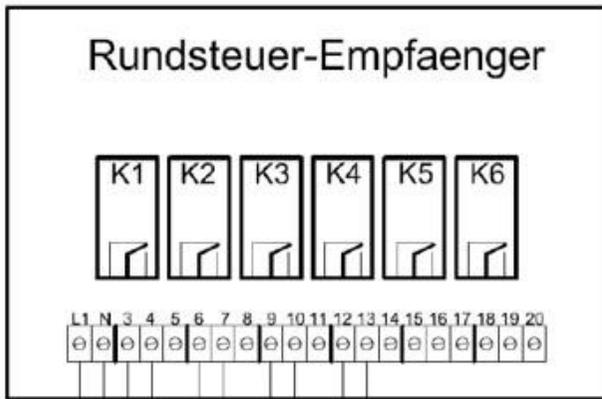
Anschluß des PRIMUS an den Rundsteuerempfänger.
