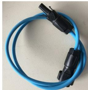
Verbindungskabel der Batterien untereinander. Stehen die DOMUS übereinander genügt eine Kabellänge von 70 cm. Die Verbindungskabel sind mit jeweils einem Stecker und einer Buchse auszuführen.
